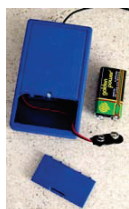
FUENTE DE ALIMENTACIÓN DE CORRIENTE CON UNA BATERÍA CORRIENTE DE 9V
